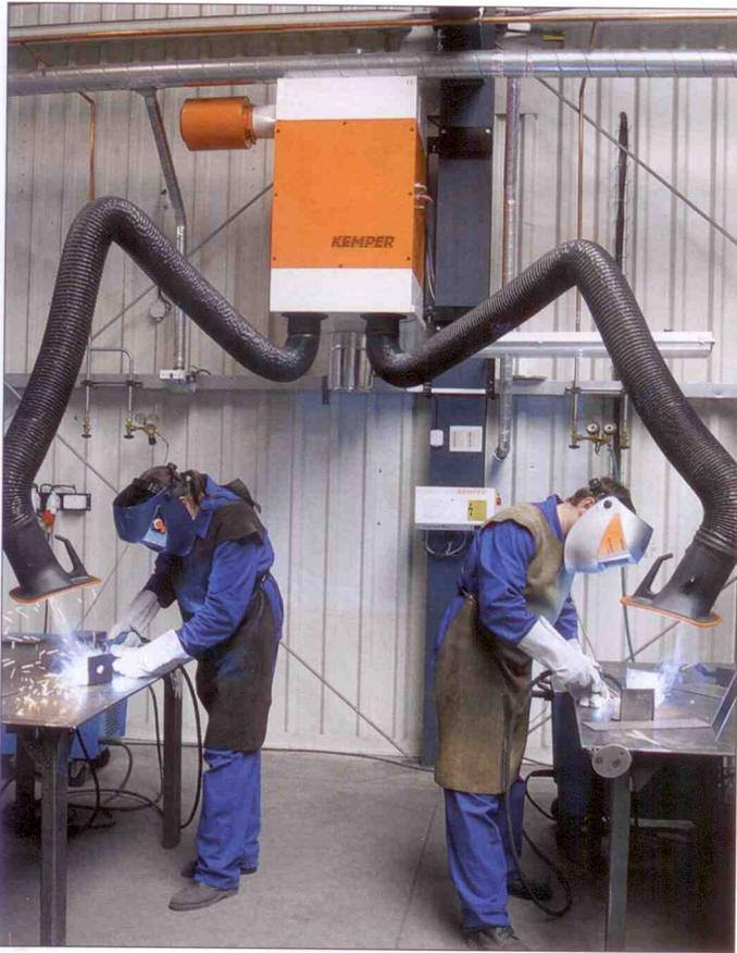
Bei wechselnden Arbeitspositionen oder dem gleichzeitigen Einsatz an zwei Arbeitsplätzen - Stationäre Patronenfilter mit zwei Absaugarmen sind eine kostengünstige Alternative zu zwei Einzelgeräten und eignen sich hervorragend für den flexiblen Einsatz in Werkstätten, an Ausbildungsplätzen oder in der Industrie.
