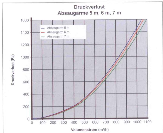
Die Darstellung zeigt den Druckverlust im Absaugarm in Abhängigkeit vom Volumenstrom.
